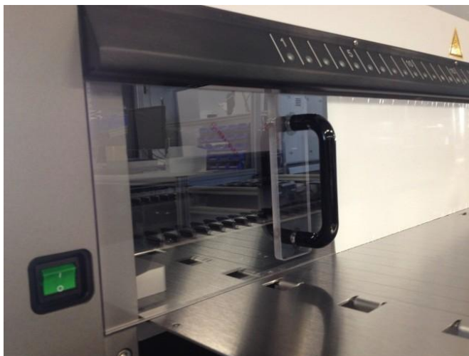
Ilustr. 24: Montarea capacului frontal UV
