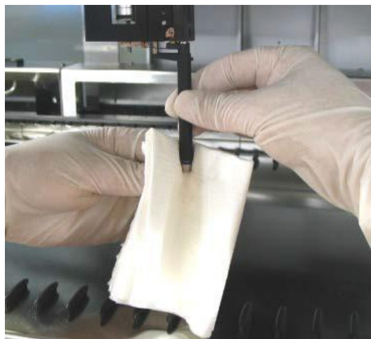
Ilustr. 23: Curățarea discului de oprire și a garniturii inelare
