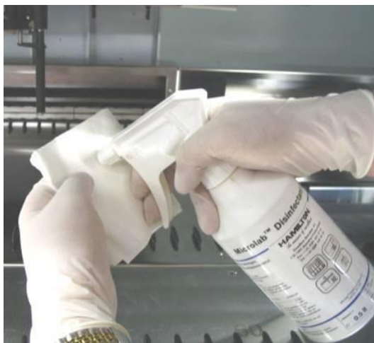
Ilustr. 23: Curățarea discului de oprire și a garniturii inelare
