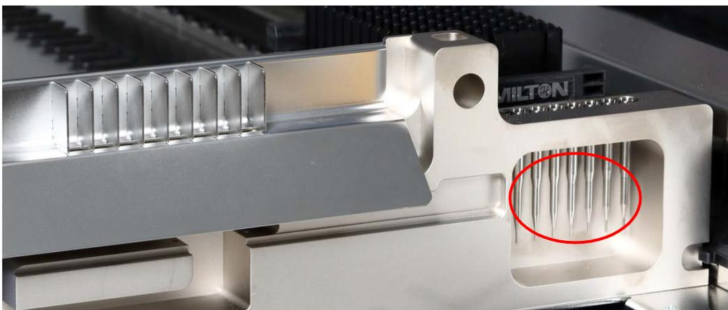
**Abb. 20: Wartungsnadeln für 1000- $\mu$ l-Pipettierkanäle**
