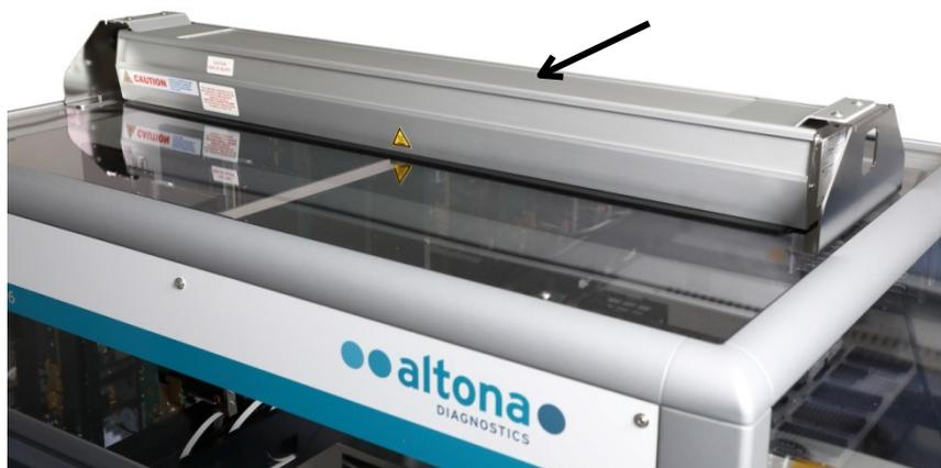
**Abb. 2: UV-Licht auf der Oberseite des AltoStar® AM16**
