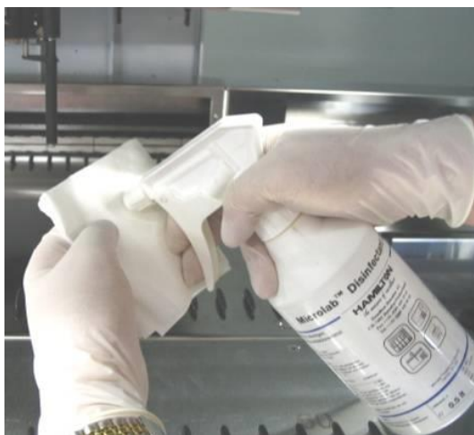
Rys. 23.: Czyszczenie krążka ograniczającego i o-ringów
