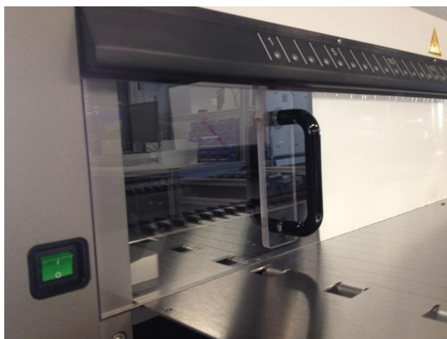
Rys. 24.: Montaż przedniej osłony UV
