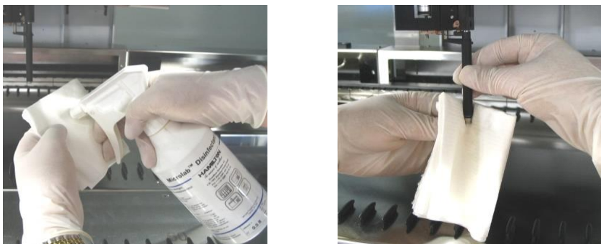
Fig. 23: Limpeza do Disco de Paragem e O-Rings
