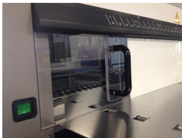
Fig. 24: Instalação da Cobertura Frontal UV
