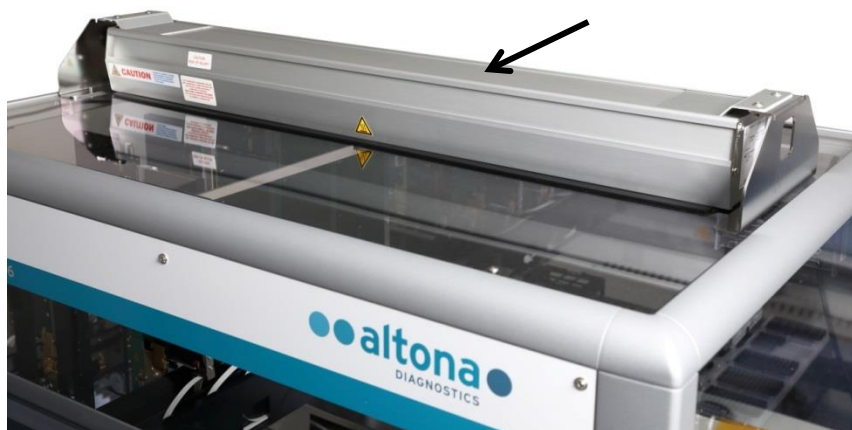
Fig. 2 : Lumière UV sur le dessus de l'AltoStar® AM16
