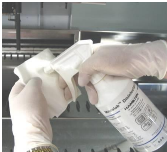
Fig. 23 : Nettoyage du disque de butée et des joints toriques
