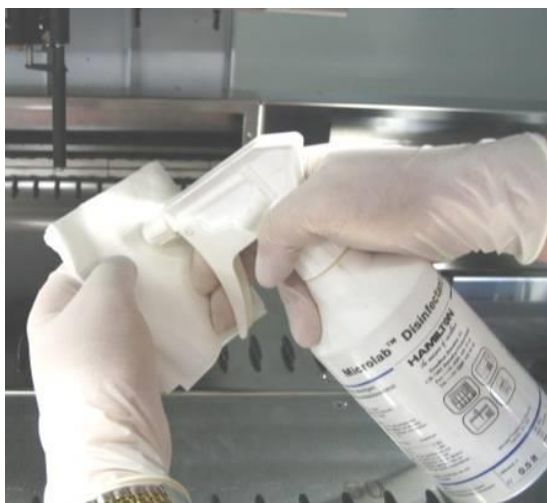
Fig. 22 : Nettoyage du manchon d'éjection des cônes
