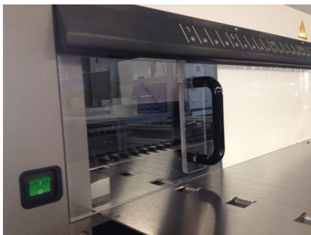
Fig. 24 : Pose du couvercle avant de protection contre les UV
