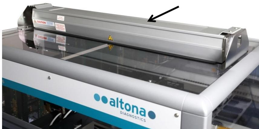
Fig. 2: Luz UV en la parte superior del AltoStar® AM16
