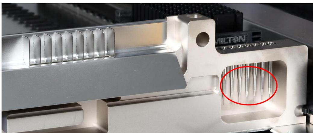
**Fig. 20: Agujas de mantenimiento para canales de pipeteo de 1000 µl**
