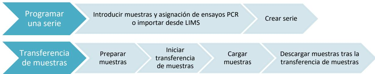
Fig. 44: Descripción general del flujo de trabajo Sample Transfer (Transferencia de muestras)
