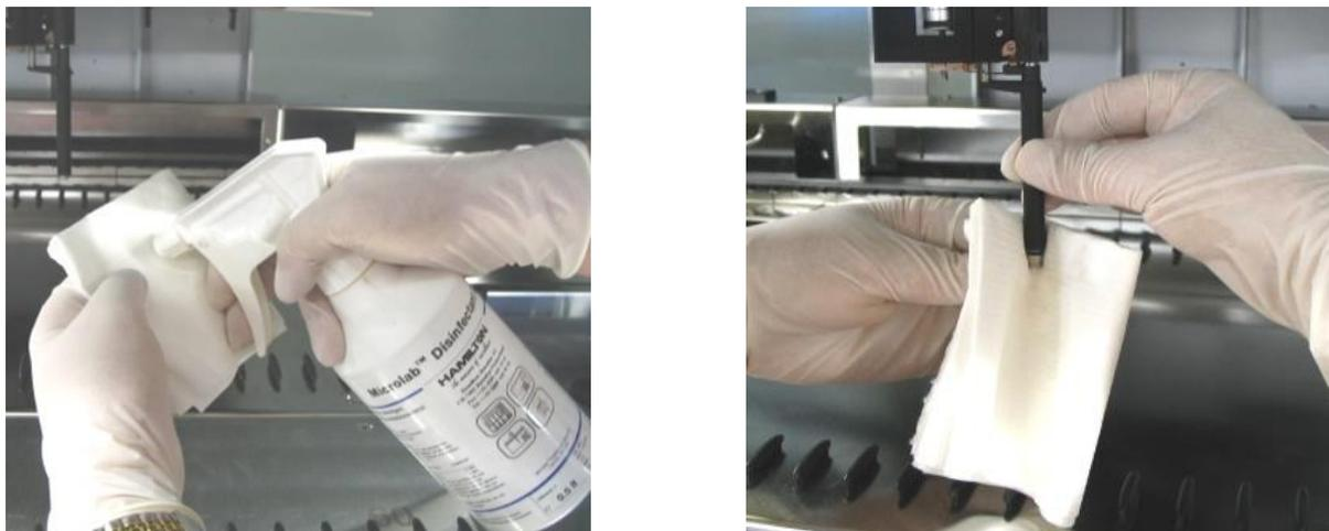
**Fig. 23: Limpieza del disco de parada y de las juntas tóricas**
