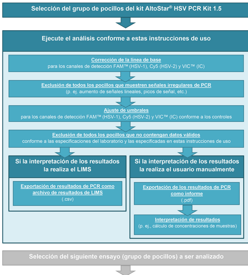
Figura 3: Proceso de análisis de datos PCR
